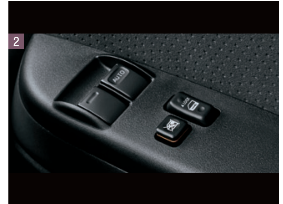
▶パワーウィンドウ (運転席・助手席) [運転席/キーOFF後作動可能ワンタッチ式・挟み込み防止機能付]
